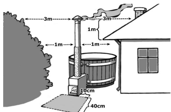
Schornsteins reicht ein geringerer seitlicher Abstand. Wenn der Schornstein näher aufgestellt werden soll, muss ein isolierter Schornstein verwendet werden, der separat zu erwerben ist.
