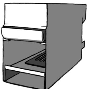
Au fond du fourneau, il y a un berceau, équipé d'une grille, et d'un passage d'air permettant le passage des flammes dans la cheminée par l'arrière. Pour l'installation, il convient de les sortir du fourneau pour le rendre plus léger.
