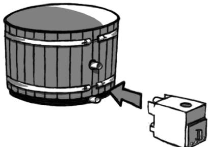
$\varnothing$  75 mm du tonneau à l'aide des tuyaux flexibles en caoutchouc. Pour ce branchement, le fourneau doit être au même niveau que le tonneau, de manière à ce que les deux soient bien posés sur le sol, et non suspendu. A côté de certains modèles de cuves, ceci nécessite le rajout d'une cale de rehaussement sous le fourneau (une dalle en béton, une brique). Le branchement des tuyaux flexibles est à le même que pour l'installation à côté d'un tonneau en bois. Mais
