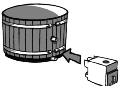
In der linken Abbildung werden die Befestigungsrohre des Kunststoffbadefasses gezeigt. In der Abbildung rechts ist CULT an einem Kunststoffbadefass angebracht.
