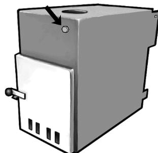
**NB !** Vérifiez que le filetage soit étanche avant la chauffe. Si le poêle fuit au niveau du filetage, il doit être resserré et/ou vérifier que le teflon soit bien en place.
