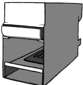
Er is een vuur plaat met vuur rooster onderin de kachel en een vuur plaat boven in de kachel. De rook zal langs de vuurplaat achter door de opening voor naar de schoorsteenpijp gaan. Haal deze onderdelen uit de kachel zodat de kachel lichter is, hierdoor wordt de installatie van de kachel makkelijker. **De vuurplaten en rooster dienen altijd in de kachel geplaatst zijn, voordat u de kachel gaat stoken!** ( zie afbeelding links).
