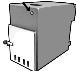
**Let op !** Controleer voor het stoken van de kachel of u de magnesium staaf goed heeft geïnstalleerd. Is de aansluiting niet waterdicht, draai de staaf aan en kijk of de O-ring is geplaatst.
