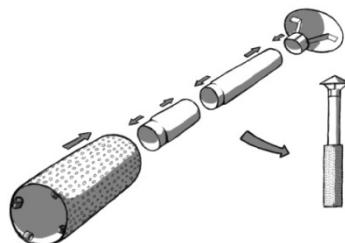
Lorsque vous vous êtes procuré un pack cheminé, celui-ci est livré en emballage séparé, composé de 4 éléments (voir figure ci-dessous). Il doit être assemblé avant l'utilisation. Retirez le film protecteur de la résistance thermique et installez la cheminée montée sur la sortie de cheminée du poêle en insérant d'abord l'embout réduit.
